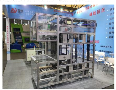
新款Z型斗式提升机既可以提升颗粒及小块状物料,也可以提升含粉量低于25%的混合型物料,提升高度可以达到20米,提升量18立方/小时□Z型斗式提升机在料斗的尺寸上延续了PP塑料料斗的特点,并结合防腐蚀、耐高温等要求,可非标定制碳钢、不锈钢等金属料斗□Z型斗式提升机可适用于化工、塑料、粮食、宠物食品、膨化食品、休闲食品、再生资源、五金、化工等行业得到了的应用Z型斗式提升机的提升速度可达20件/分钟,
